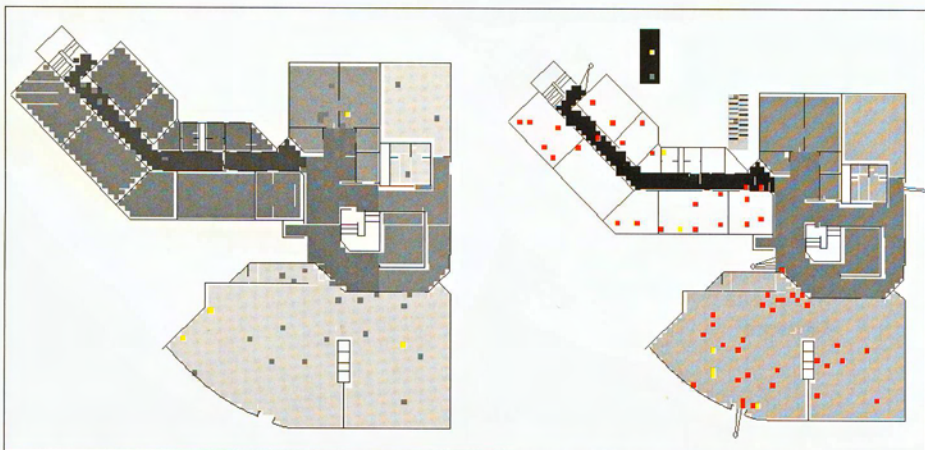
Simulation kombiniert mit Rauchsimulation in Exodus. Die grauen Schattierungen zeigen unterschiedliche Rauchkonzentrationen.
